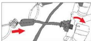
Lösen Sie das Original Kabelsatz und die Stecker des STEINBAUER Kabelsatzes zwischenstecken.
