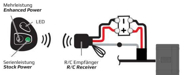
Rote Leitung an Batterie Plus, schwarze Leitung an Batterie Minus (Masse) schließen. Die graue Leitung der Funkfernbedienung an die Select-Leitung (graue Leitung der Zusatzelektronik) schließen.
