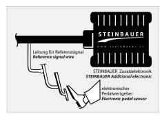
Die Leitung für das Referenzsignal an die Leitung des elektronischen Pedalwertgebers löten.
