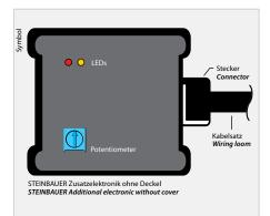
rt • - Spannungsversorgung falsch angeschlossen oder Elektronik defekt
