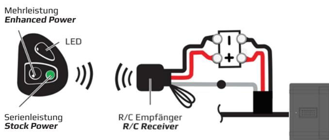
Rote Leitung an Batterie Plus, schwarze Leitung an Batterie Minus (Masse) schließen. Die graue Leitung der Funkfernbedienung an die Select-Leitung (graue Leitung der Zusatzelektronik) schließen.
