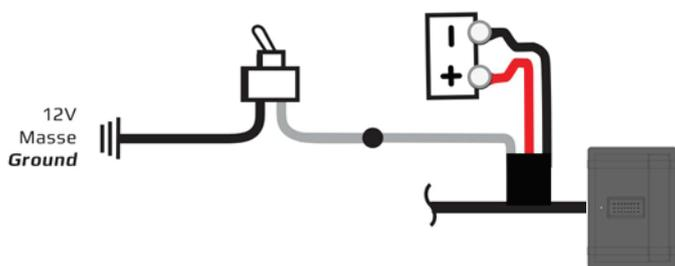
Die graue Leitung vom Kippschalter an die Select-Leitung (graue Leitung der STEINBAUER Zusatzelektronik) schließen. Die schwarze Leitung an Batterie Minus (oder Masse) schließen.
